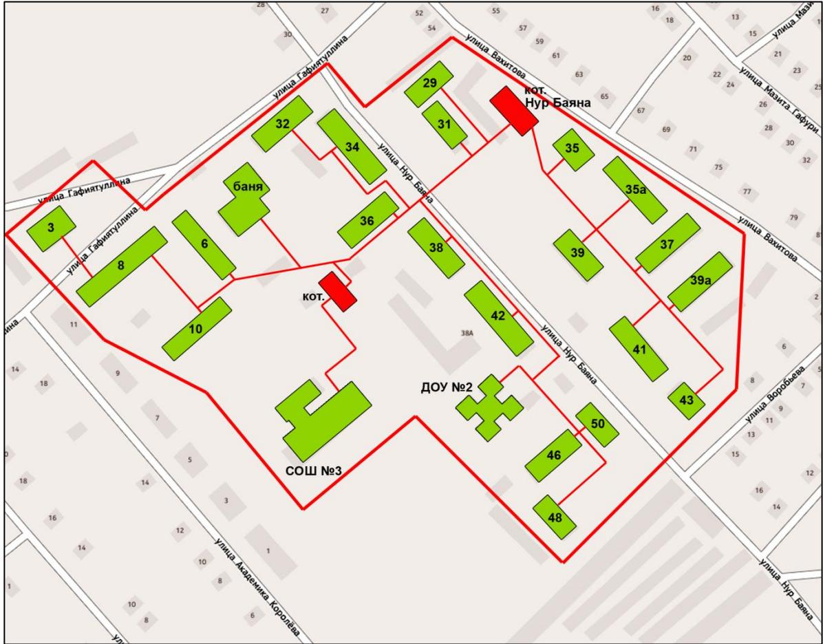
рис. 11 - Зона действия котельной по ул. Тинчурина, 18
